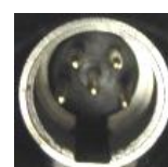
Разъем MIC/HF (Switchcraft 5-pin)
